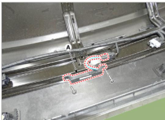
4. 分离固定夹，并拆卸后保险杠缓冲梁总成(A)。
